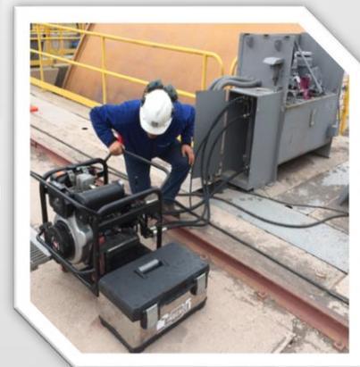
**Unidad Auxiliar Motor Diésel 10 Hp, Bomba 4 lts. por minuto**
